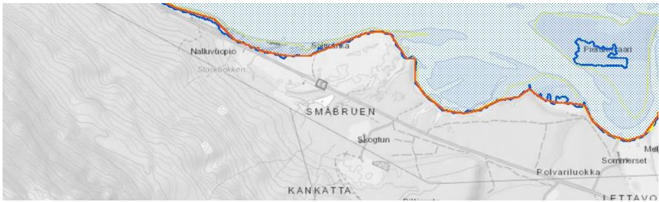
Fig. 15. Oppskyllingshøyde for flodbølge som følge av fjellskred på Nordnes.
